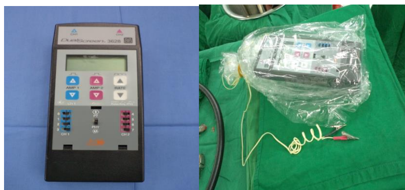
ภาพที่ 6 เครื่องกระตุ้นไฟฟ้าที่ผิวสมอง ชนิด Dual screen
